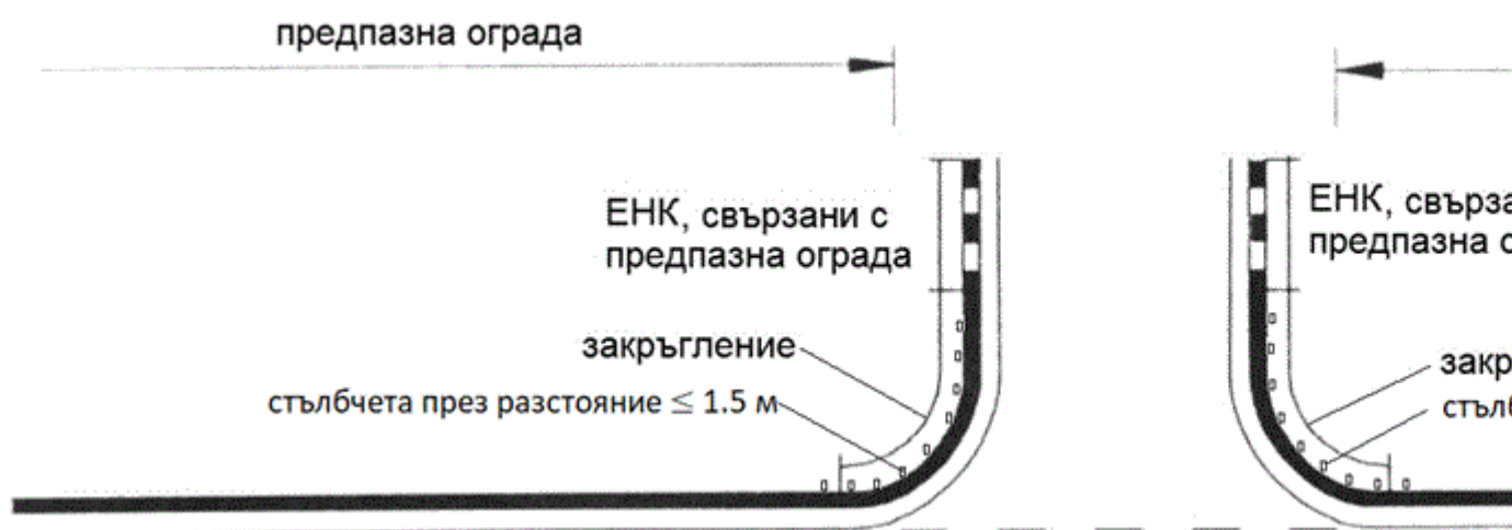
Фиг. 9в. Прекъсване на предпазната ограда, скосена навън 1:12, закръгления и ЕНК
