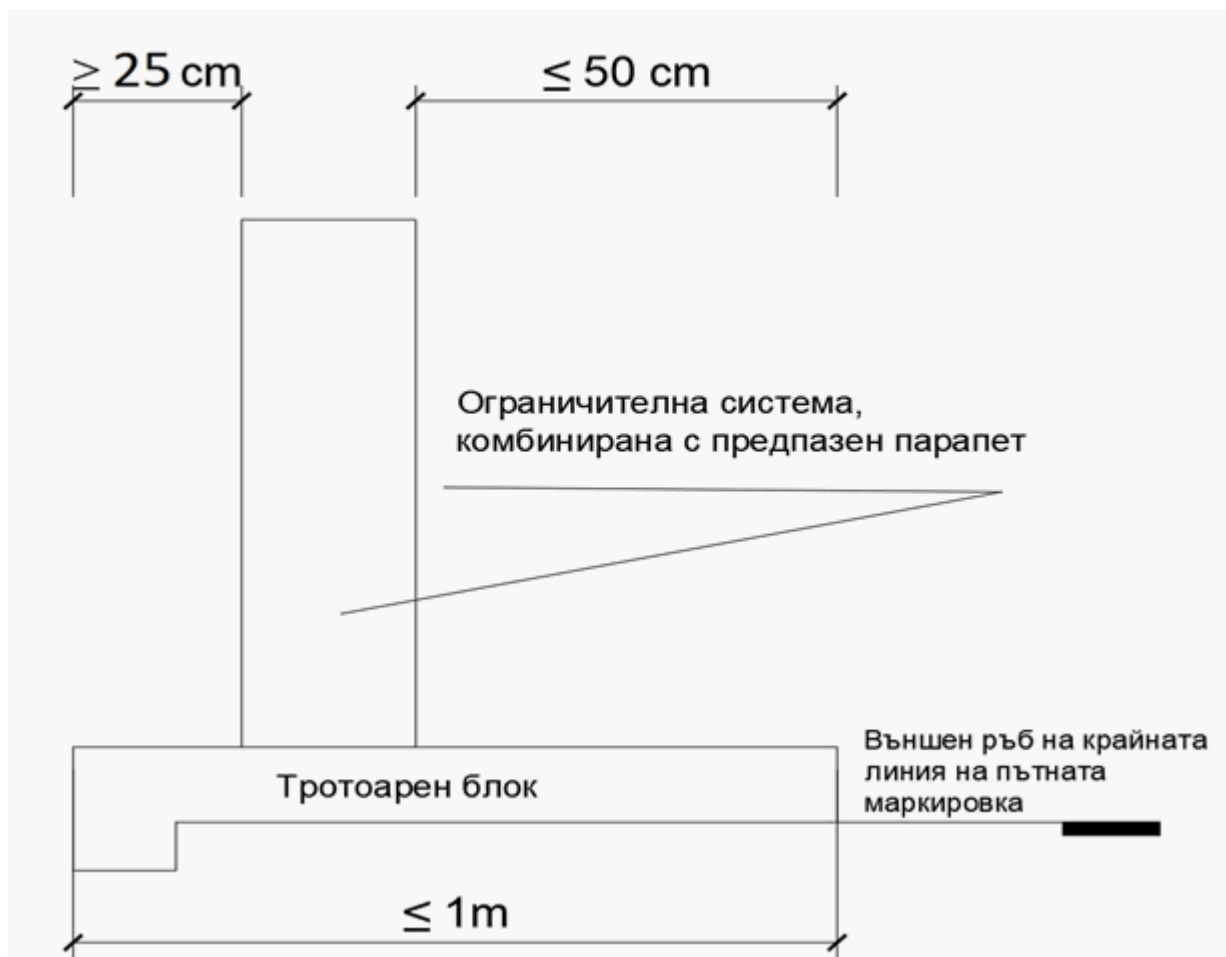
Фиг. 24. Място на ограничителна система, комбинирана с предпазен парапет върху тротоарен блок
